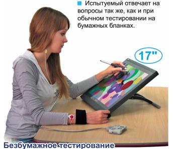
■ Малогабаритный беспроводной блок регистрации физиологических данных АБП-4 обеспечивает комфортную регистрацию при проведении тестирования.
